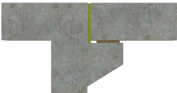
• Traditionele oplossing met draagconsole
