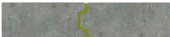
• Traditionele oplossing met tand-en-groef
